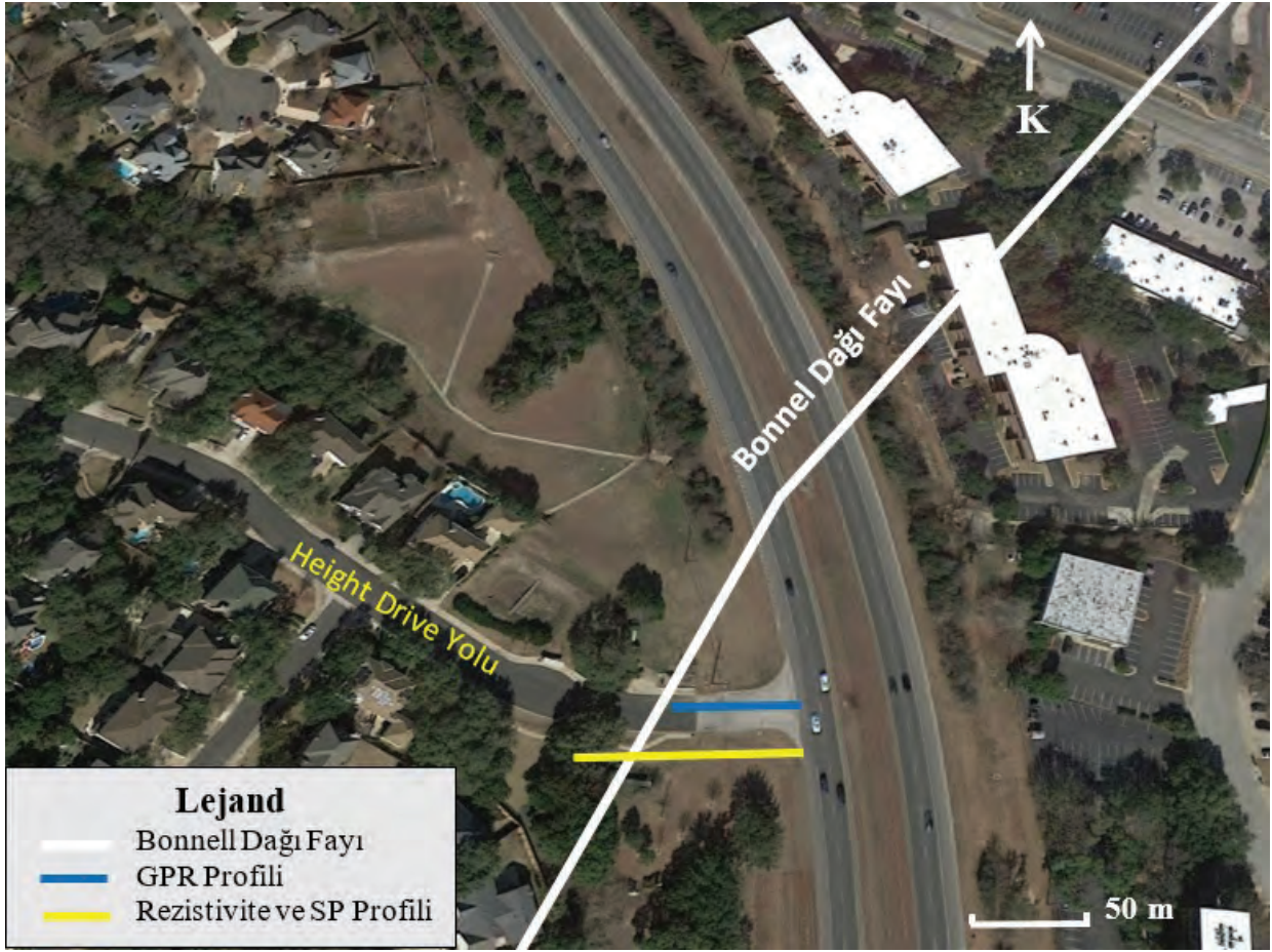
Şekil 18. Height Drive yolu üzerindeki Bonnell Dağı Fayının ve jeofizik ölçümlerin alındığı profilleri gösteren harita.
